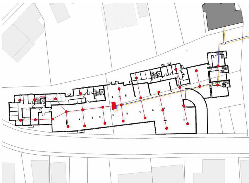
Abb. 2: Schema eines kalten Nahwärmenetzes
